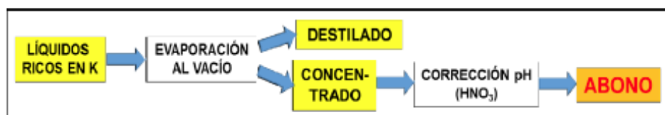
Figura 9. Tratamientos de los vertidos ricos en K para obtener un concentrado con posibilidades de emplearse agrónicamente
