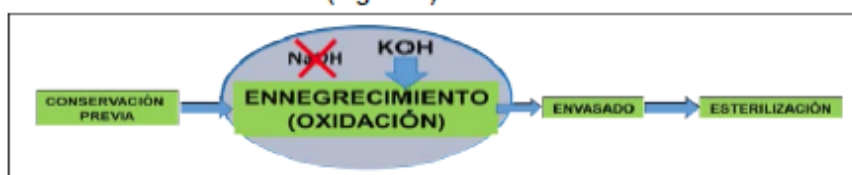
Figura 6. Etapa del proceso de elaboración de aceitunas negras en la que se sustituye el NaOH por KOH
