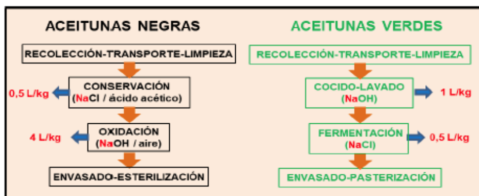
Figura 1. Procesos de elaboración de aceitunas negras por oxidación y verdes estilo español. Volumen de vertidos que se originan por cantidad de aceituna transformada
