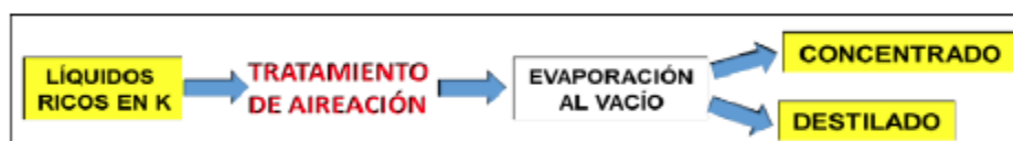
Figura 11. Tratamientos de los vertidos ricos en K para obtener un concentrado con posibilidades de emplearse agrónomicamente y un destilado con ligera carga contaminante
